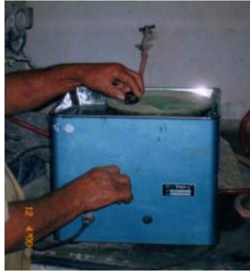
Figura No. 16: Proceso de pulido y lustrado de granates en el Laboratorio de Petrografía.
